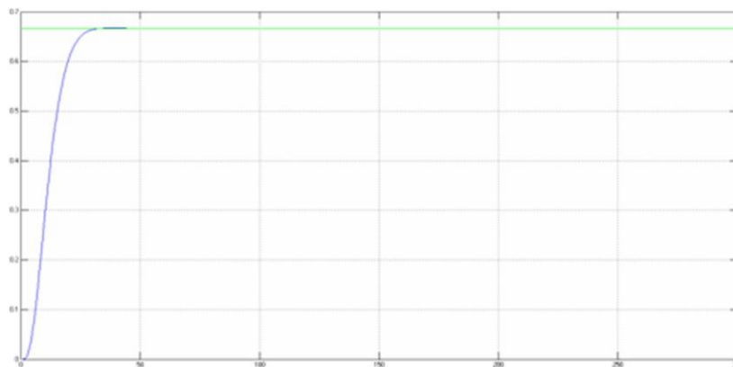
2.9 - сурет – ПД-басқару заңымен АБЖ-дегі температураның өтпелі процесі
