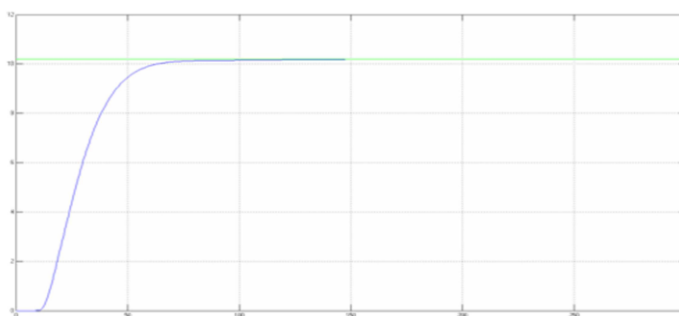
2.10 - сурет – ПИД және ПД-басқару заңымен АБЖ-дегі рН-параметрінің өтпелі процесі
