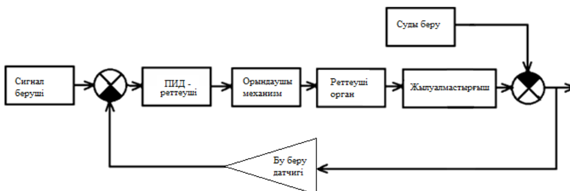
2.7 - сурет – Буқыздырғыштағы температураның АБЖ құрылымдық сұлбасы
